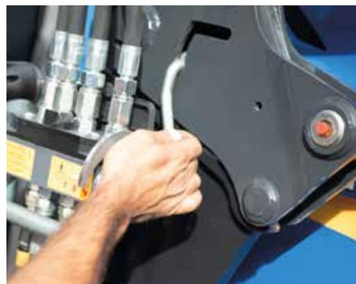
**3** Путем опускания запирающего рычага погрузчик надежно фиксируется в монтажном элементе. После этого еще немного приподнимите погрузчик.
