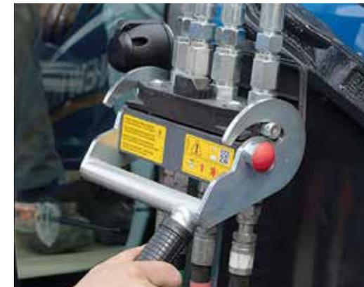
**2** Система Hydro-Fix позволяет одним движением подключить все гидрелинии к трактору. Погрузчик слегка приподнимается, чтобы зафиксировать фиксатор в крюке направляющей.
