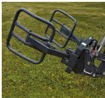
**2** Наклоните рабочий орган – запирающий механизм зафиксируется автоматически.
