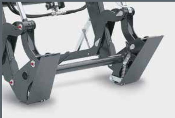
Быстросменная рама Skid Steer обеспечивает водителю хорошую обзорность рабочего органа – идеально для работ с пикой для тюков и вилами для поддонов.
