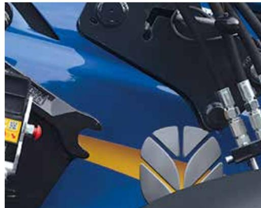
**1** Въездная система устроена таким образом, что погрузчик скользит по монтажному элементу, пока фиксатор не коснется верхнего края направляющей.
