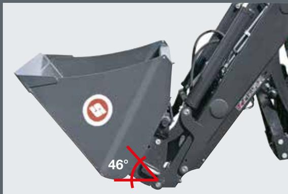
Ничего не выпадет: Превосходный угол зачерпывания позволит избежать просып материала при погрузочно-разгрузочных работах.
